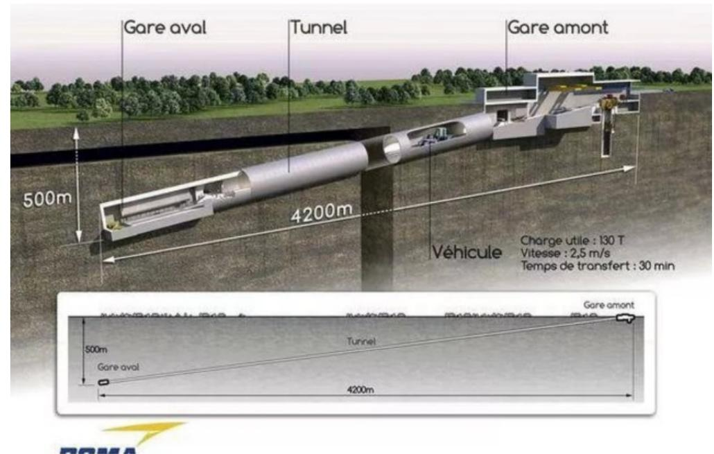
Pour transporter les colis de déchets radioactifs de la surface vers l'installation souterraine de stockage à 500 mètre de profondeur, l'ANDRA envisage de creuser une descenderie de 12 km de long.
